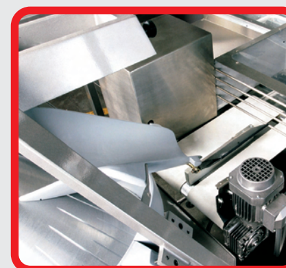
Raddoppiatore pezzi per cella 2 vie. Produzione oraria 2500 pezzi. Double piece system for prover at 2 rows. Hourly production of 2500 pieces.
