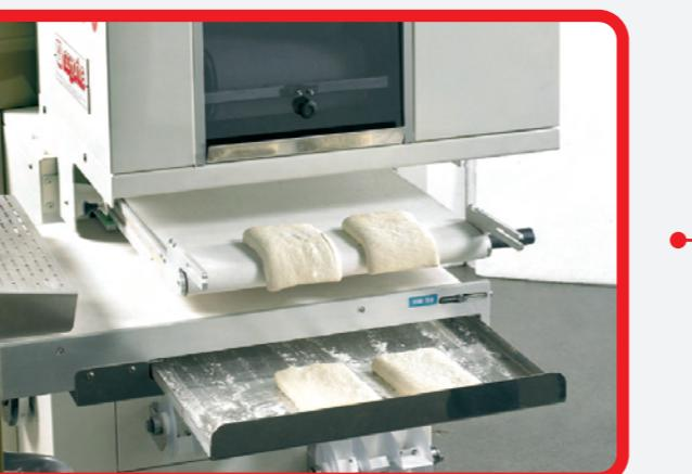
Particolare del dispositivo prelievo ciabatte e/o pasta solo spezzata.
