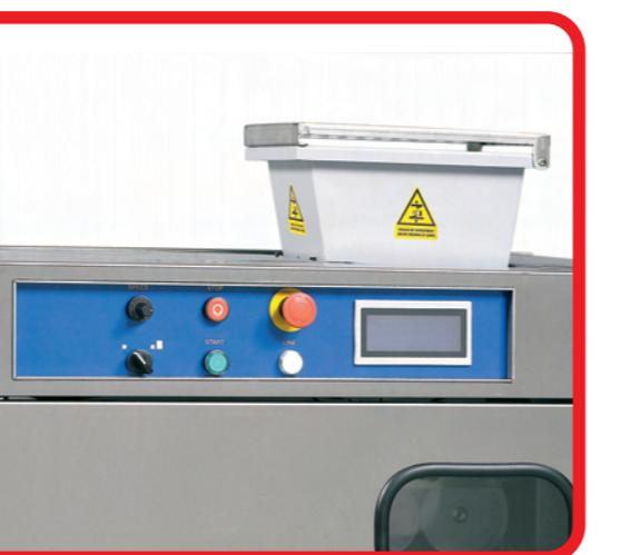
Particolare del pannello comandi delle versione elettronica con touch screen e PLC a 50 programmi memorizzabili.
