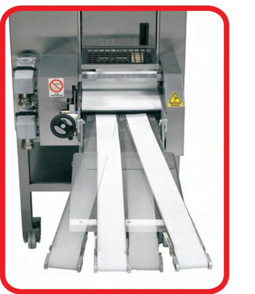
Come optional è disponibile il sistema di raddoppio ad aria compressa da 2 a 4 pezzi per poter caricare celle di puntatura o sistemi automatici.
