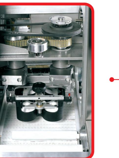
Particolare della camera di arrotondatura a doppio effetto, regolabile a seconda del peso da produrre per un migliore risultato del prodotto finito. Il tappeto di arrotondatura è facilmente intercambiabile ma di estrema robustezza date le caratteristiche del materiale usato. Il contrappeso del sistema di arrotondatura e la movimentazione a cinghie rende la macchina particolarmente stabile durante la fase di arrotondatura.
