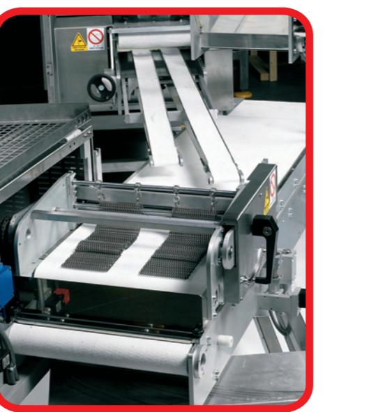
Particolare della stazione di formatura. In evidenza lo scarico dalla spezzatrice con doppi tappeti, cilindri di laminazione, reti di avvolgimento estraibili e scarico sul tappeto inferiore per l'eventuale schiacciamento o allungamento.
