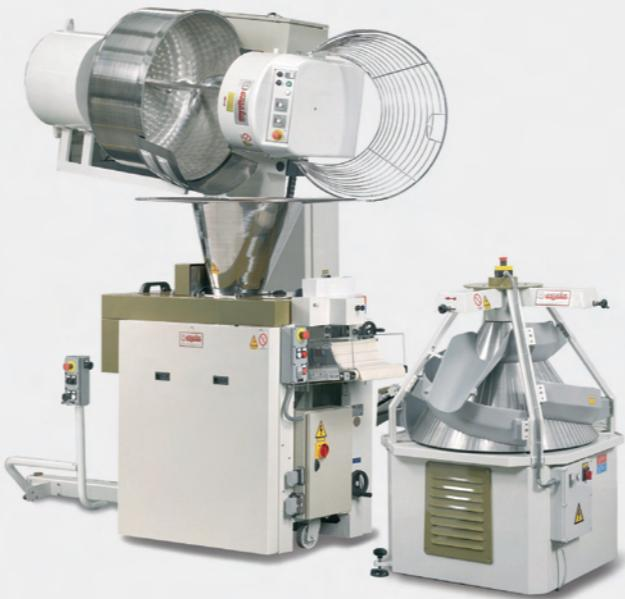
La Spezzatrice SVP può essere alimentata da un'impastatrice autoribaltante o da un sollevatore per carrelli e può inoltre essere abbinata a varie macchine quali arrotondatrici o formatrici. Abbinamento ad arrotondatrici coniche o a nastri contrapposti per paste particolarmente appiccicose.
